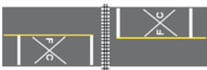
los ángulos izquierdo y derecho de la “X”. Antes y después de la “X” se coloca una línea transversal de detención. En vías de más de una senda, esta marca debe repetirse en cada una de ellas.
